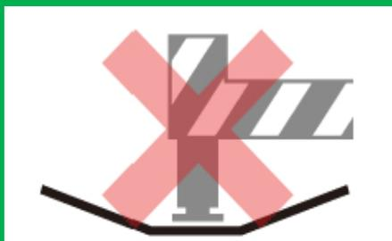
軟弱な地盤上では、クレーン車のアウトリガーの受け板としての使用はできません。クレーン車が転倒する危険性があります。
